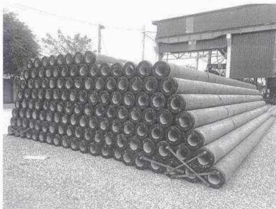
Bước 9: Lưu bãi và vận chuyển cọc đến công trình thi công.
