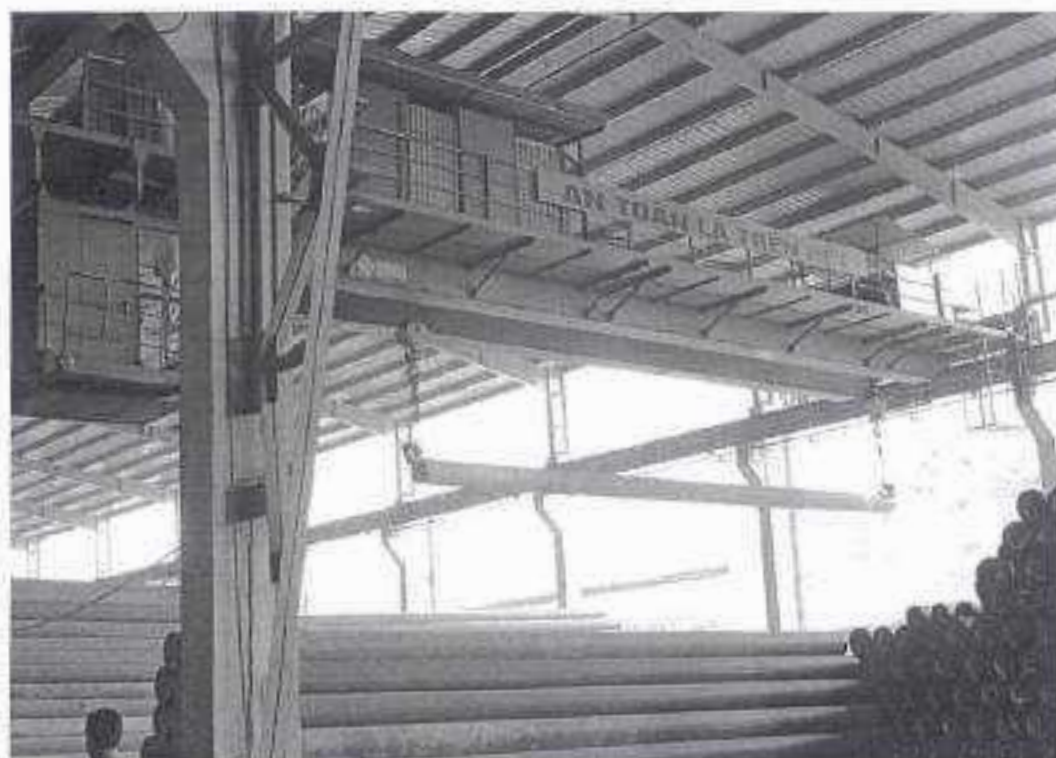
Bước 9: Lưu bãi và vận chuyển cọc đến công trình thi công.
